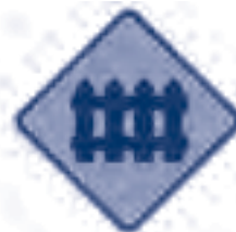
Figura No. 9. Señal Paso a Nivel (con barrera)
