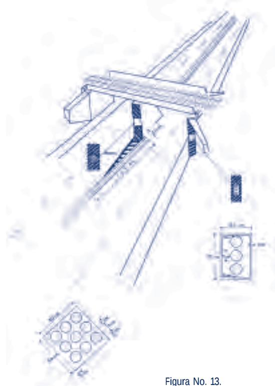
Figura No. 13. Demarcaciones de aproximación a Obstáculos
